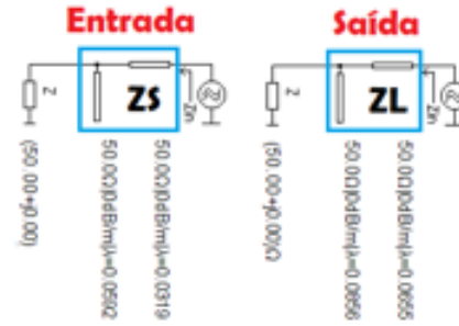
Figura 7. Diagrama ilustrativo do casamento necessário para atender aos requisitos na entrada e saída do amplificador.
