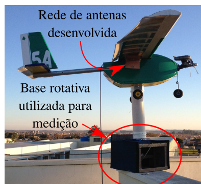
Figura 7. Ambiente de medição em campo distante do protótipo embarcado.
