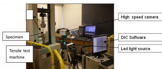
Fig. 1. Esquema de montagem para a realização do ensaio de tração e vídeo. Adaptado de [9].
